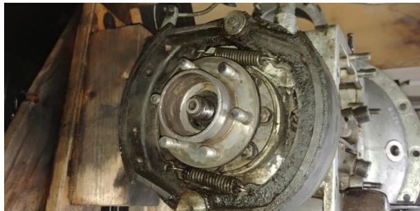
Kardanová brzda - kompletní rozebrání a renovace
