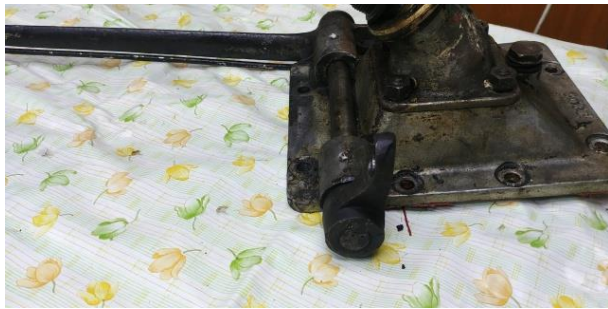
Víko převodovky s řadicí pákou a pákou kardanové brzdy před a po renovaci
